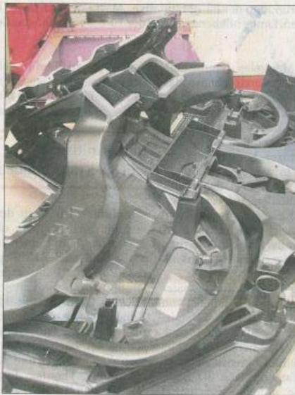
Die Kunststoff-Kanäle für die Luftführungsanlage für der umgedrehten Unterseite der Front-Innenpartie des BMW Elektromobils 3 i werden in Thimmendorf gefertigt. Foto: Karl-Heinz Putzmann
